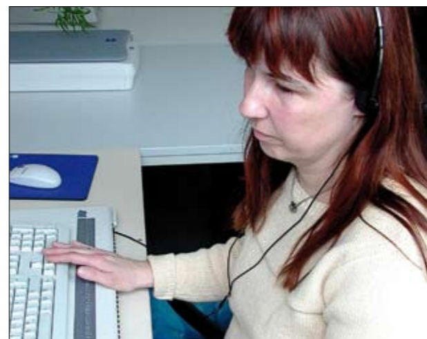
Braille-Zeile – Lese-Werkzeug für blinde PC-Nutzer
